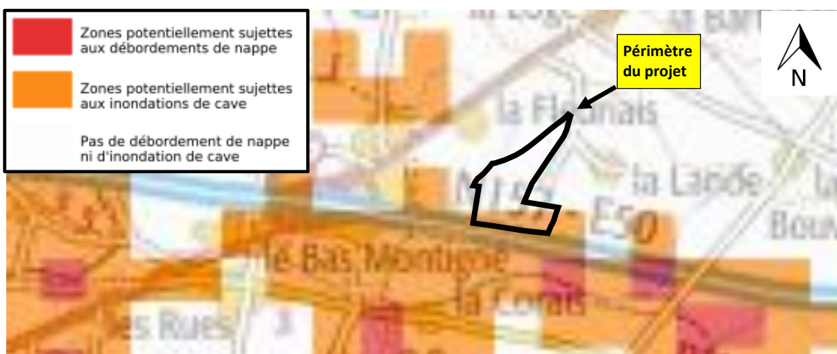
Carte des zones sensibles aux débordements de nappe ou inondation de cave.
