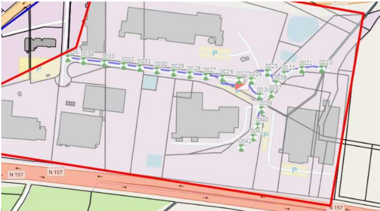
Le réseau d'éclairage public à proximité du projet d'extension (Source : SDE 35)
