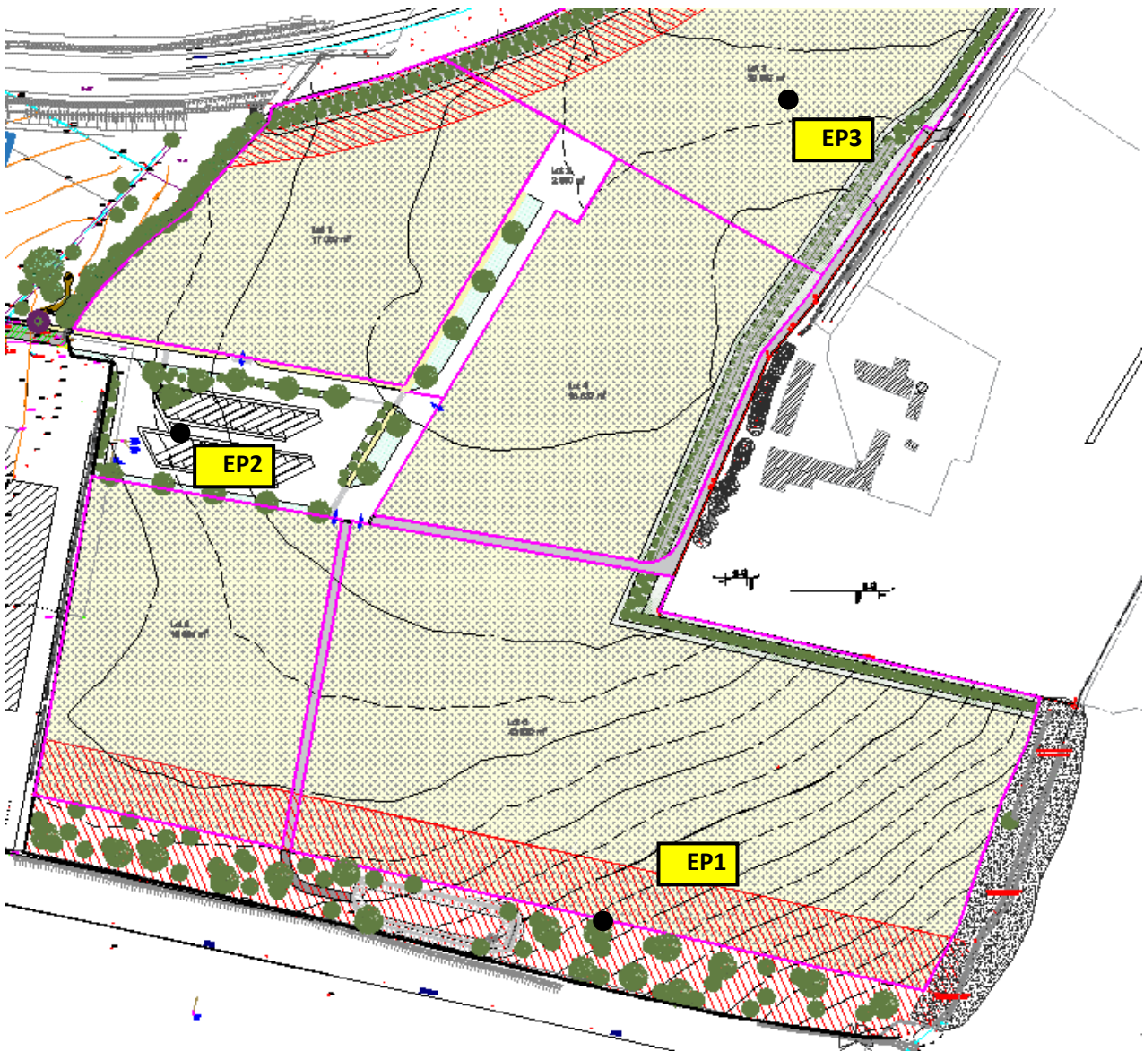
Localisation des tests de perméabilité.
